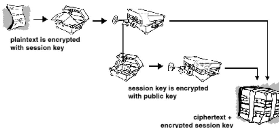
FIGURE 1.23 – Encodage d'un message à l'aide de GPG
